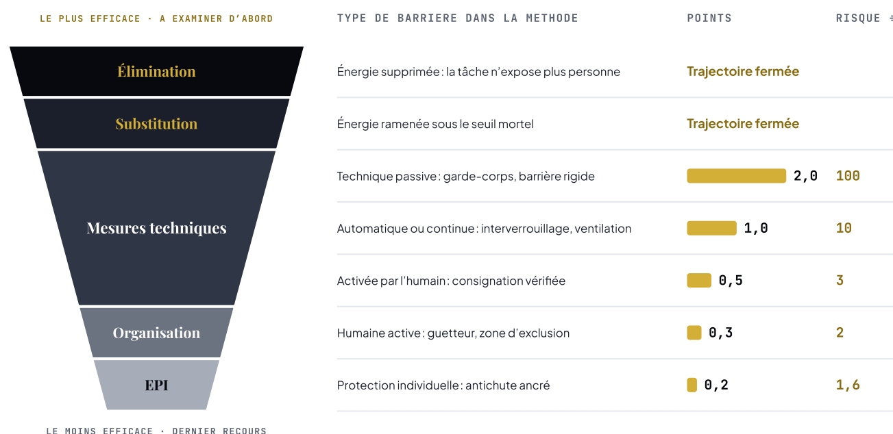
Figure 2. La hiérarchie des mesures de maîtrise, rapportée aux types de barrières et aux points de protection (proposition méthodologique v2.0 [19]). Les points sont des conventions de planification, pas des probabilités de défaillance mesurées sur site ; ils ne s'emploient pas en évaluation quantitative des risques.
