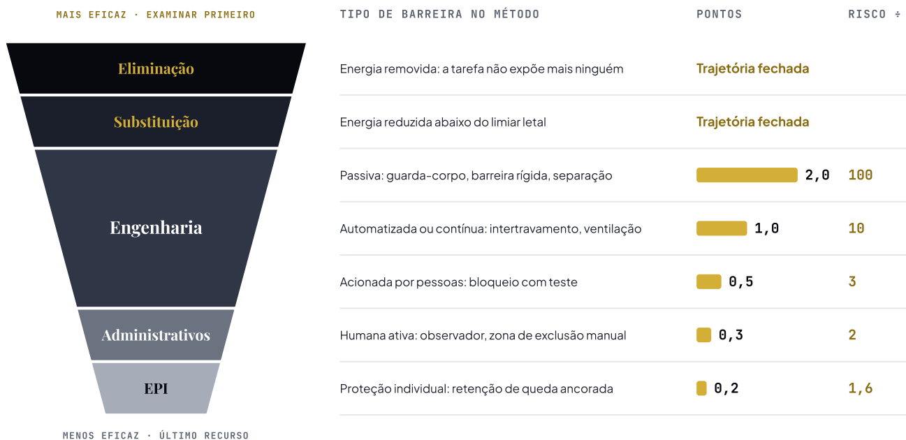
Figura 2. A hierarquia de controles, traduzida em tipos de barreira e pontos de proteção (proposta metodológica v2.0 [19]). Os pontos são convenções de planejamento, não probabilidades de falha medidas em campo, e não devem ser usados em avaliação quantitativa de riscos.
